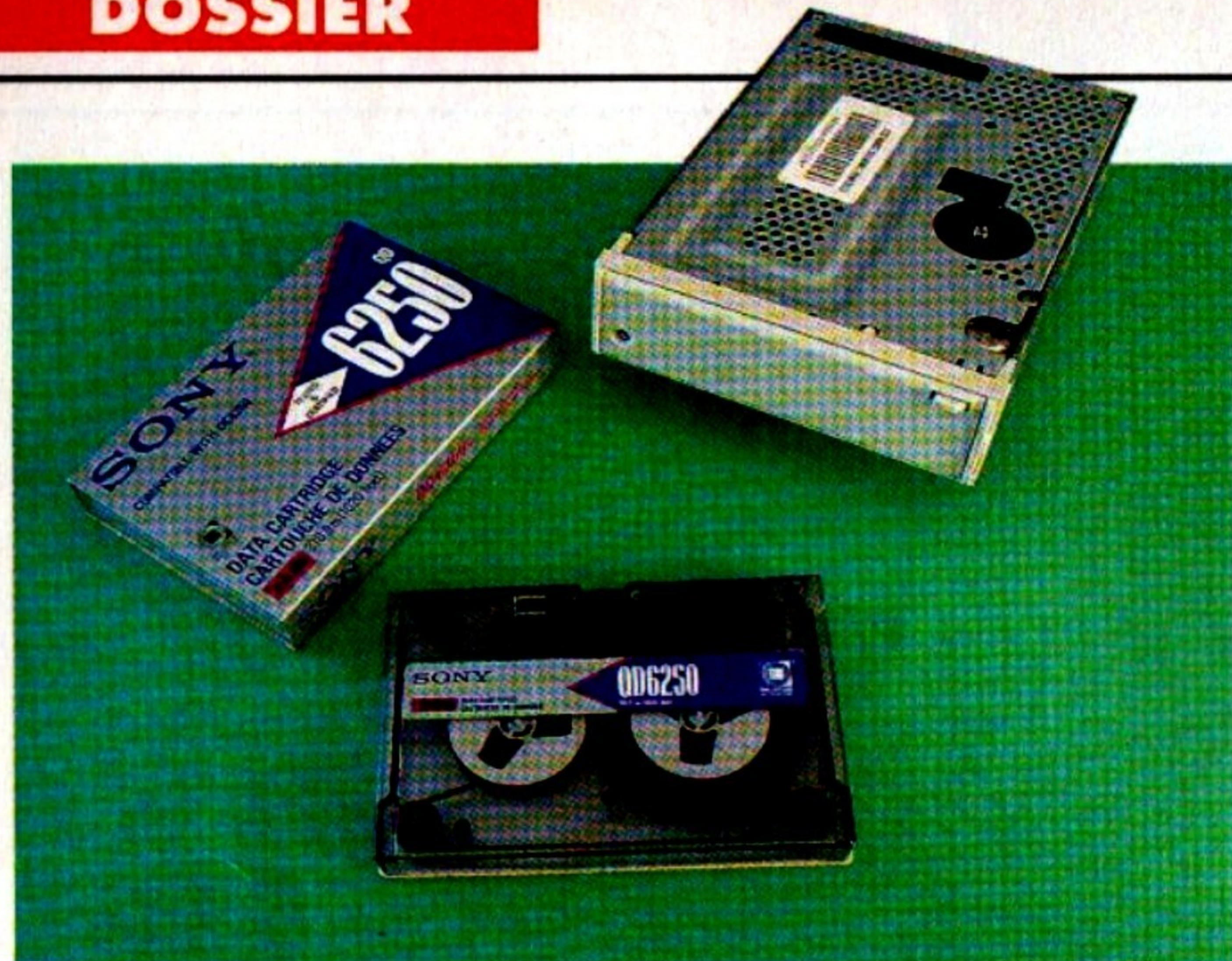
Lo Streamer Tandberg TDC 3660 ha interfaccia SCSI e usa cartucce da 250 Mb QD6250, funziona anche con Amiga e controller GVP.
